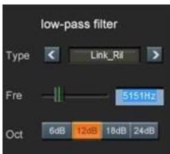
Low-pass filter는 고음부분의 특정 주파수 이하만 통과할 수 있게 하여, 그 이상의 소리의 잡음을 사전에 차단해 주는 효과를 지니고 있고, 3가지의 타입이 있습니다. 또는 각자의 취향에 따라 Fre 부분과 Oct 변경을 통해서도 세팅이 가능합니다.
